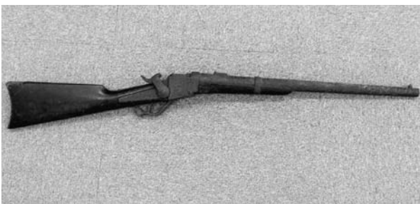
寸法は全長95.5cm、銃身長50.9cm、口径1.3cm。機関部の引き金を引く右側上部に「STARR ARMS CO. YONKERS N. Y.」の刻印が刻まれています
